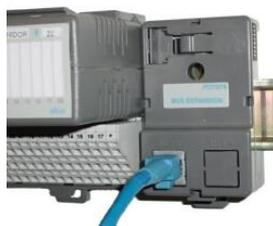
Figura 3-6 Módulo Expansor
