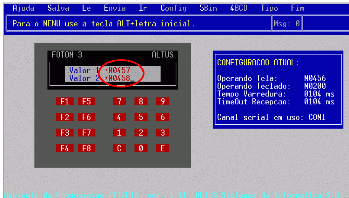
Figura 6-4 Exemplo de Configuração do Foton 3 com o PROFOTON
