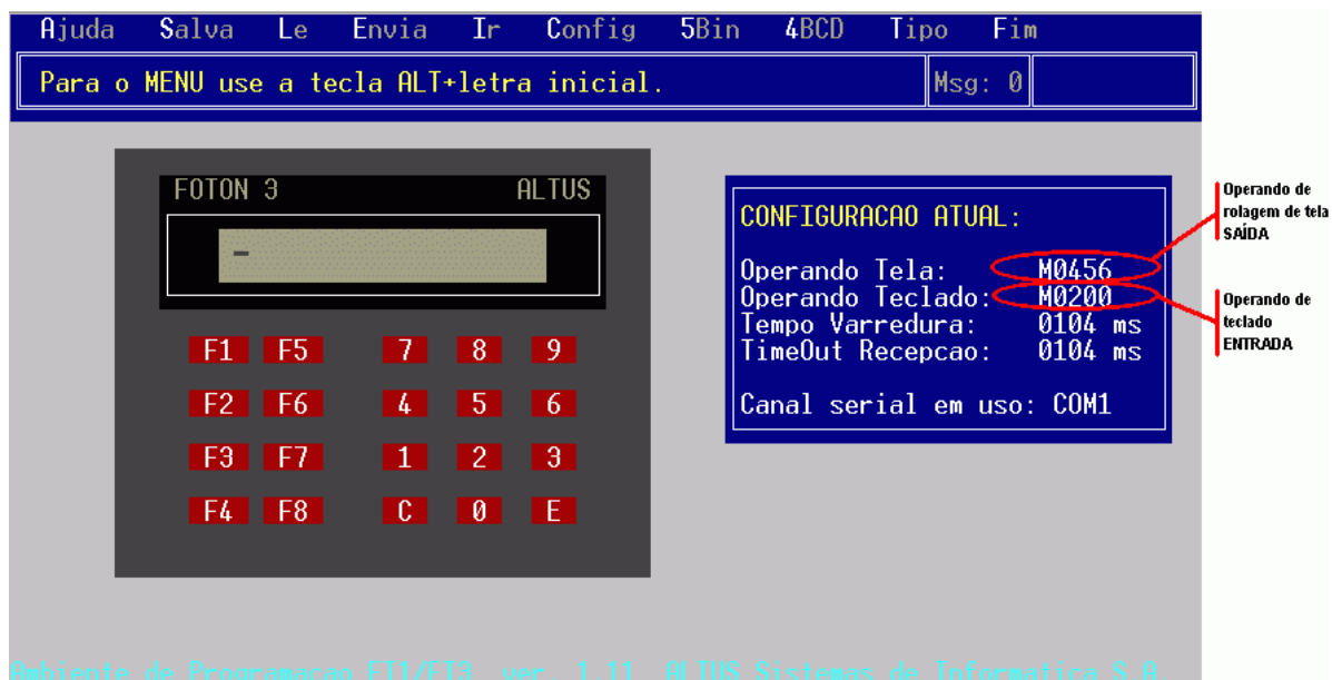
Figura 6-3 Exemplo de Configuração do Foton 3 com o PROFOTON
