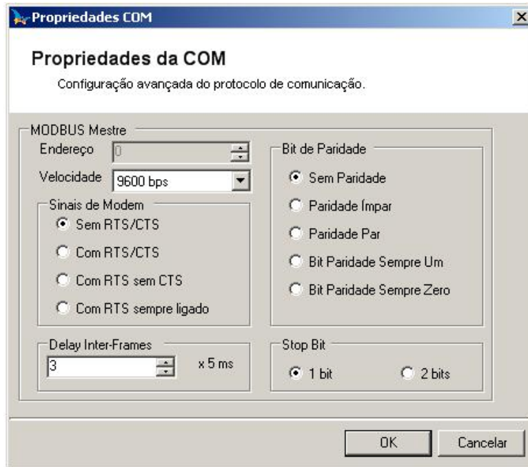
Figura 3-5. Propriedades do canal serial no protocolo MODBUS mestre
