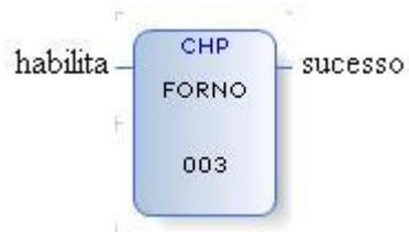
Ao ser energizada a entrada da instrução CHP, será chamado o Módulo procedimento P-Forno.003.
