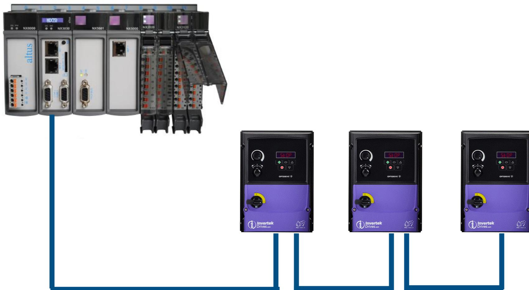
Porta Ethernet dupla Não necessita switch para rede;
