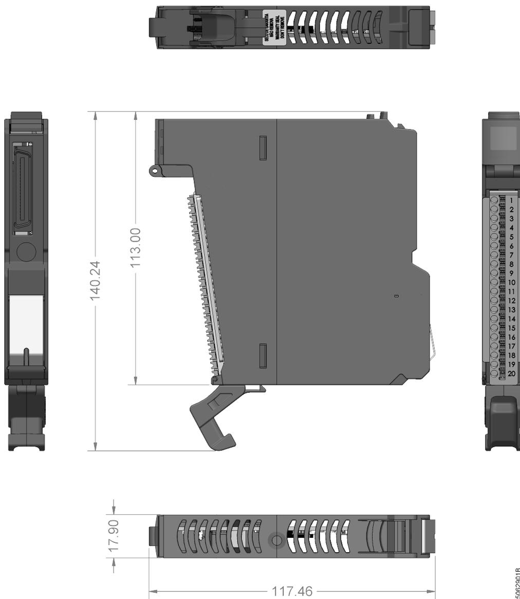
Figura 17: Módulo Nexto Jet de E/S de 18 mm
