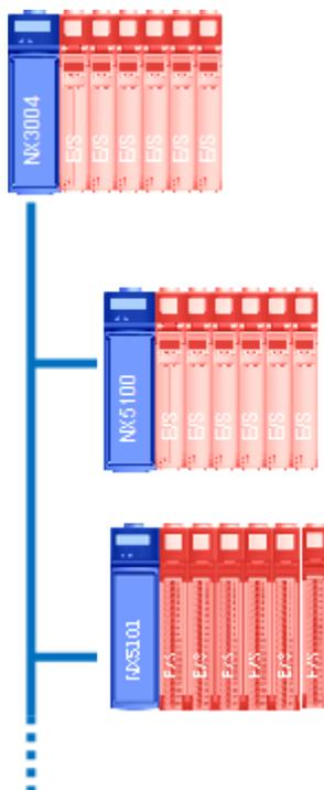
Figura 13: Cabeça de Rede de Campo MODBUS
