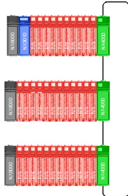
Figura 9: UCP Simples com Expansão de Barramento com Loopback e Módulos Nexto Jet
