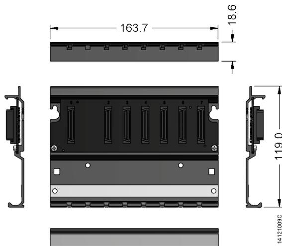
Figura 21: Bastidor de 8 Posições (Sem Troca a Quente)
