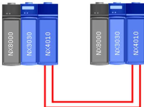
Figura 15: Configuração Mínima de um CP Redundante - NX3030
