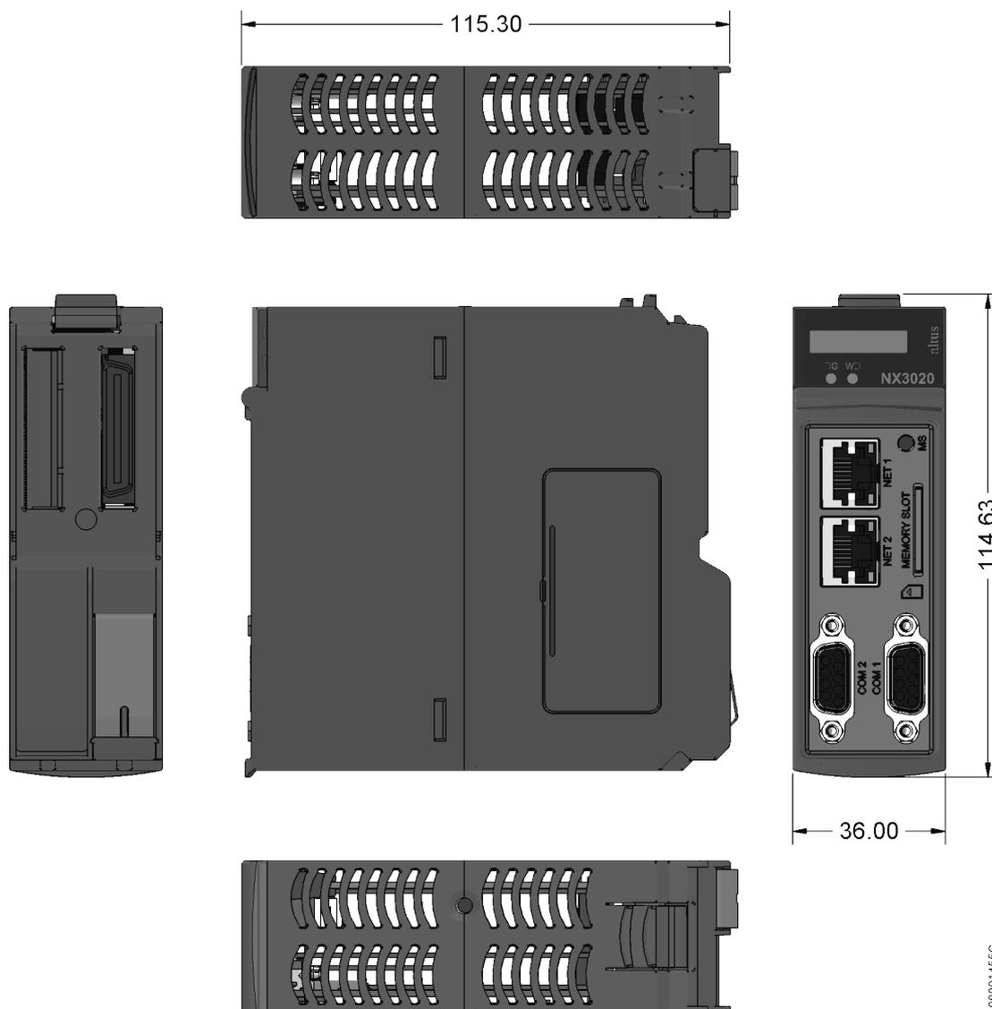
Figura 19: Módulo UCP NX3020 de 36 mm
