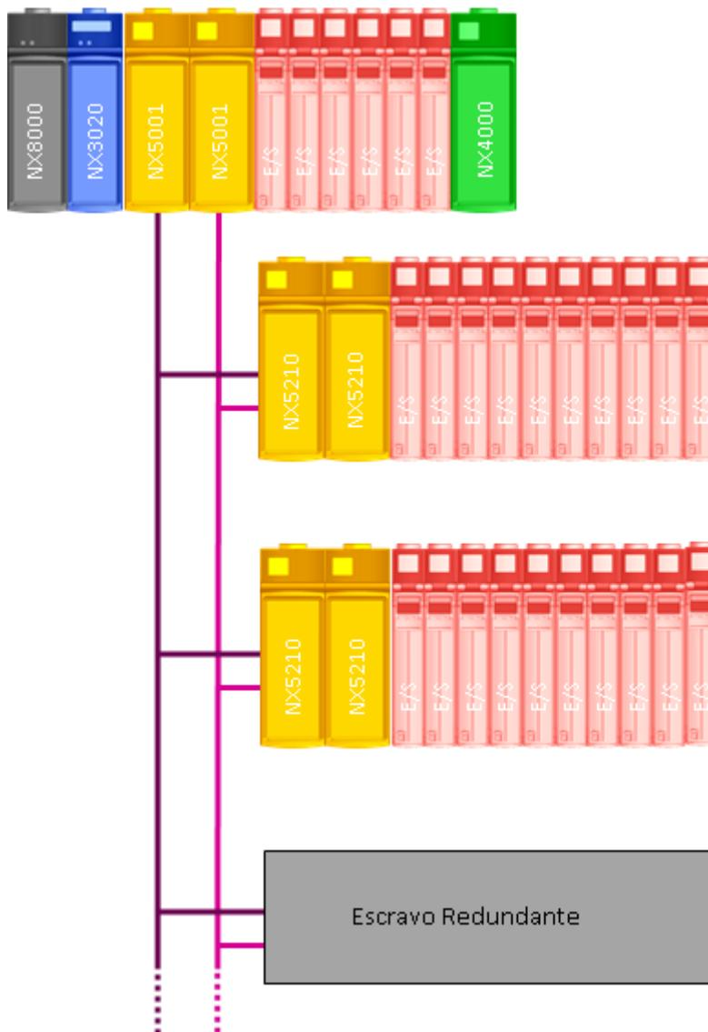
Figura 12: Interfaces de Rede de Campo com Redundância
