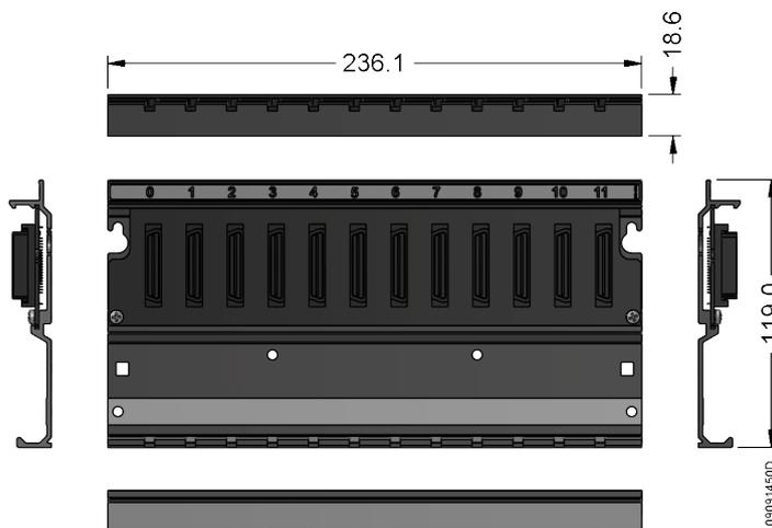
Figura 23: Bastidor de 12 Posições
