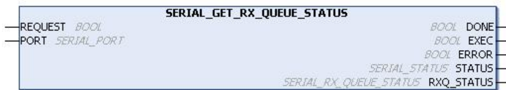
Figura 157: Bloco para Visualizar o Status da Fila RX
