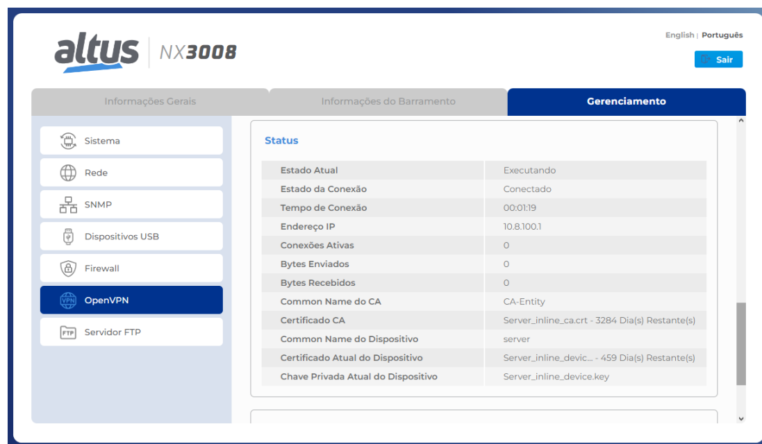
Figura 187: Tabela de Status OpenVPN com Funcionalidade Ativada
