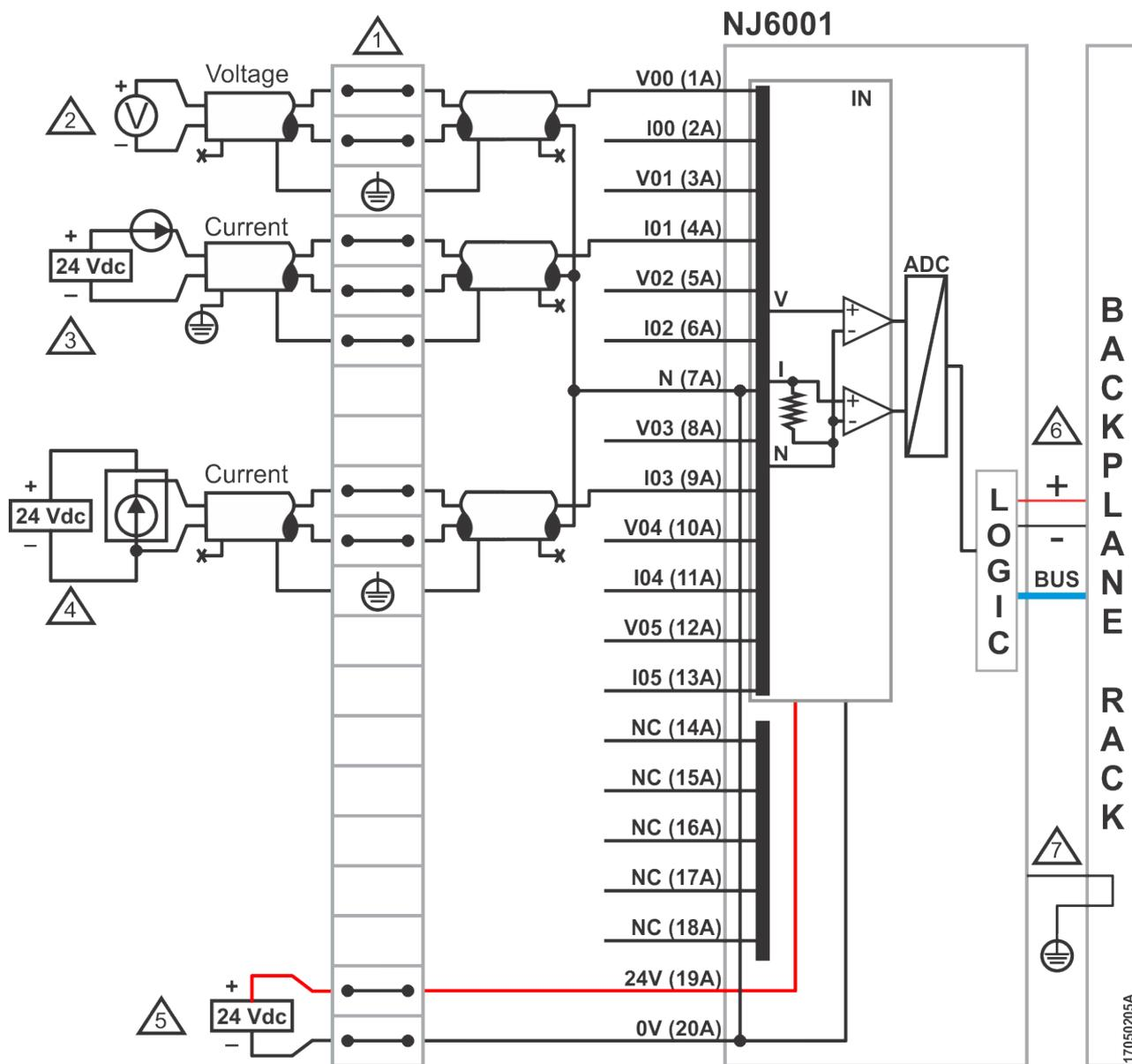
Figura 3: Diagrama Elétrico
