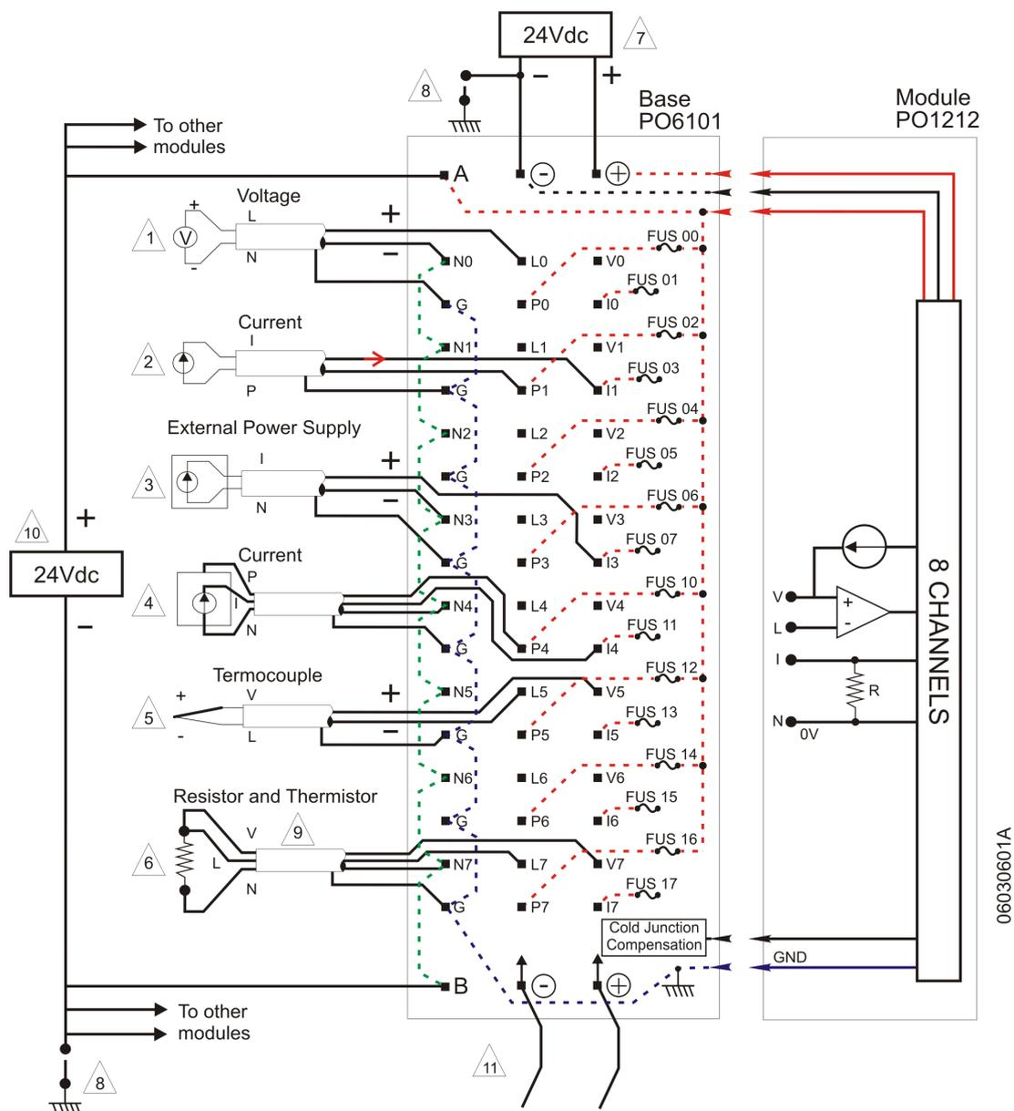
A figura abaixo demonstra a ligação elétrica do módulo PO1212 com as bases analógicas PO6104 ou PO6004. Para a base P6004 os fusíveis, indicados na figura como FUS 0x, devem ser desconsiderados.
