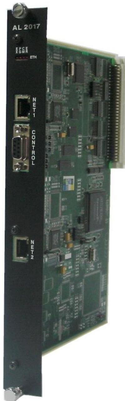
Figura 2-1. Coprocessador de redundância AL-2017
