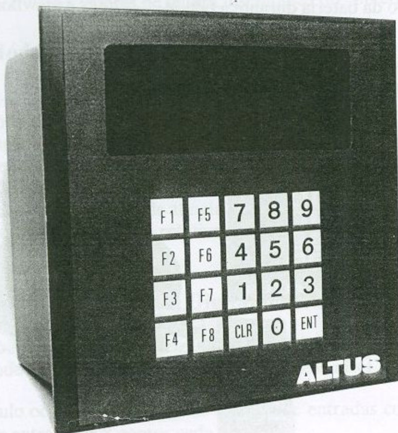
Figura 38 - Interface com Teclado e Display (AL-1406)
