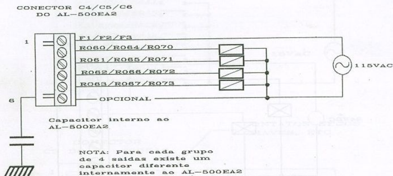
Figura 60 - Conexão Elétrica às Saídas do AL-500EA2
