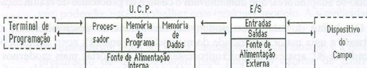
Figura 1 - Diagrama de Blocos Generalizado de um CP
