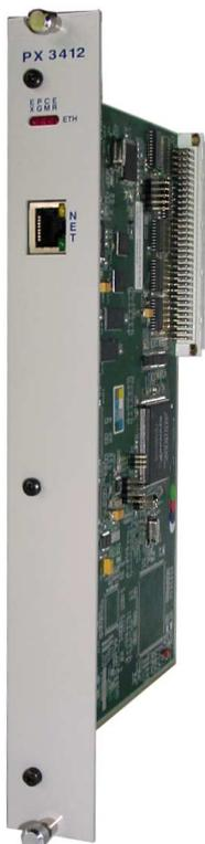
A interface PX3412 possibilita a conexão do CP a redes de comunicações abertas que seguem o padrão TCP/IP. O módulo possui interface elétrica 10/100BaseT, através de um conector RJ45 (UTP, ou par trançado não blindado).
