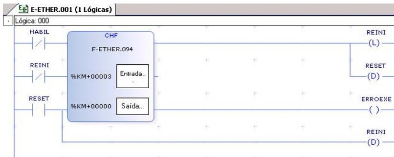
Sugere-se a inclusão da lógica ao lado no módulo principal E001 do programa aplicativo. A lógica garante que um comando de reconfiguração seja disparado automaticamente após um comando de RESET ser executado.
