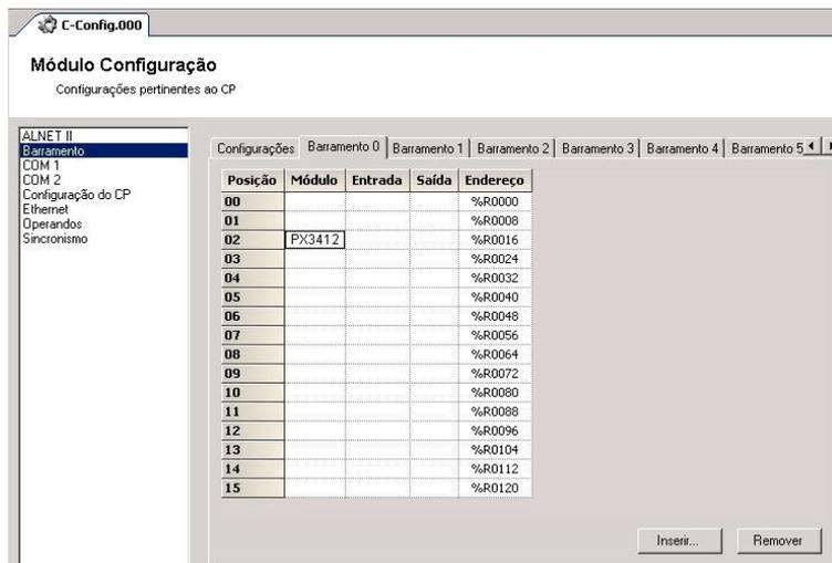
A interface deve ser declarada no barramento 0 da UCP, utilizando o programador MasterTool, através da opção <Barramento...>. Consulte a CT do bastidor para saber as posições válidas do barramento onde a interface Ethernet pode ser instalada (módulos inteligentes).
