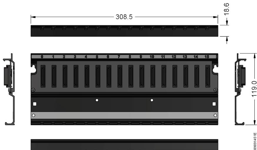
Figura 28: Bastidor de 16 Posições
