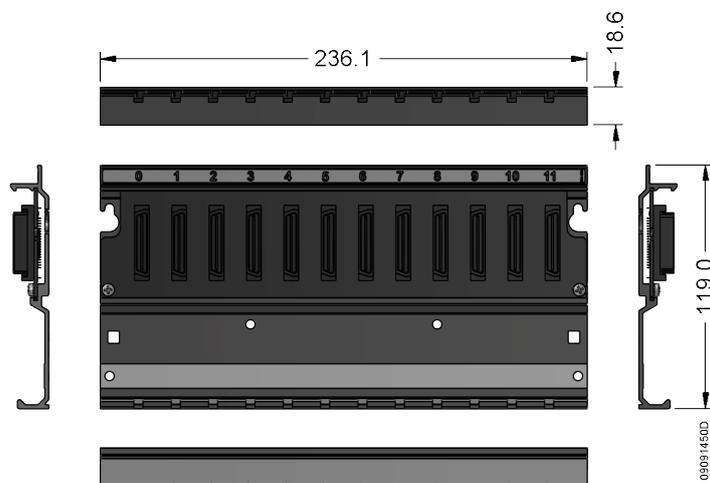
Figura 27: Bastidor de 12 Posições
