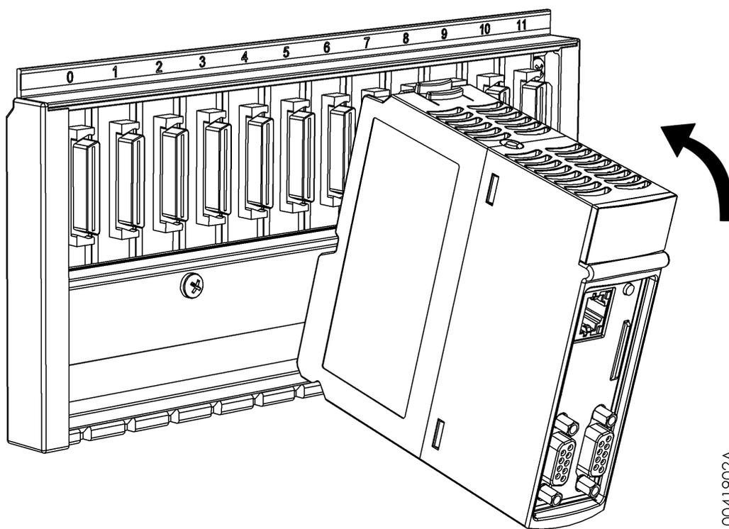
Figura 49: Movimento para Encaixe no Bastidor
