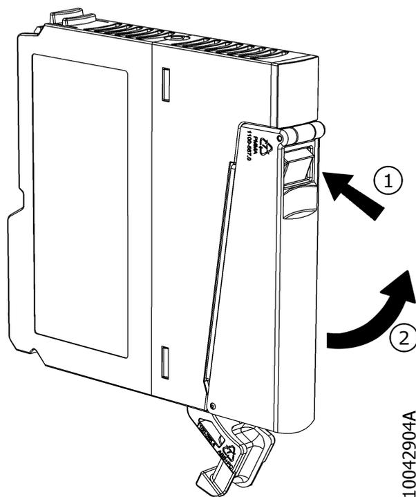
Figura 59: Movimento para Remoção do Borne de E/S Módulo Nexto
