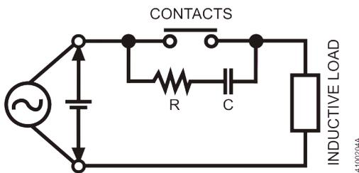
Figura 38: Circuito RC paralelo com os contatos
