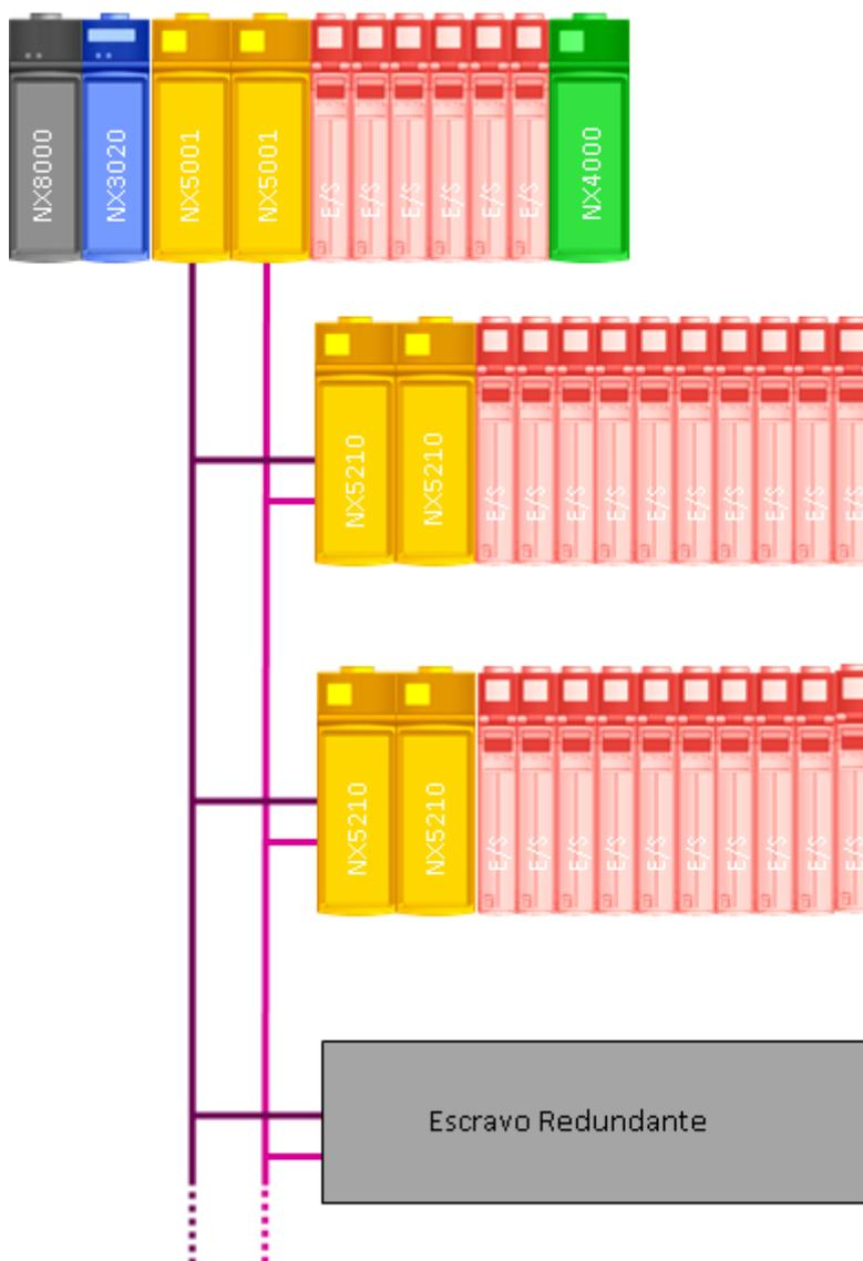
Figura 11: Interfaces de Rede de Campo com Redundância
