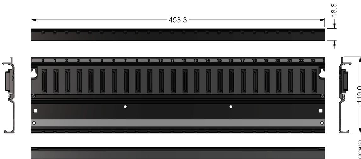
Figura 29: Bastidor de 24 Posições
