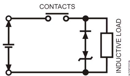
Figura 36: Circuito com diodo zener
