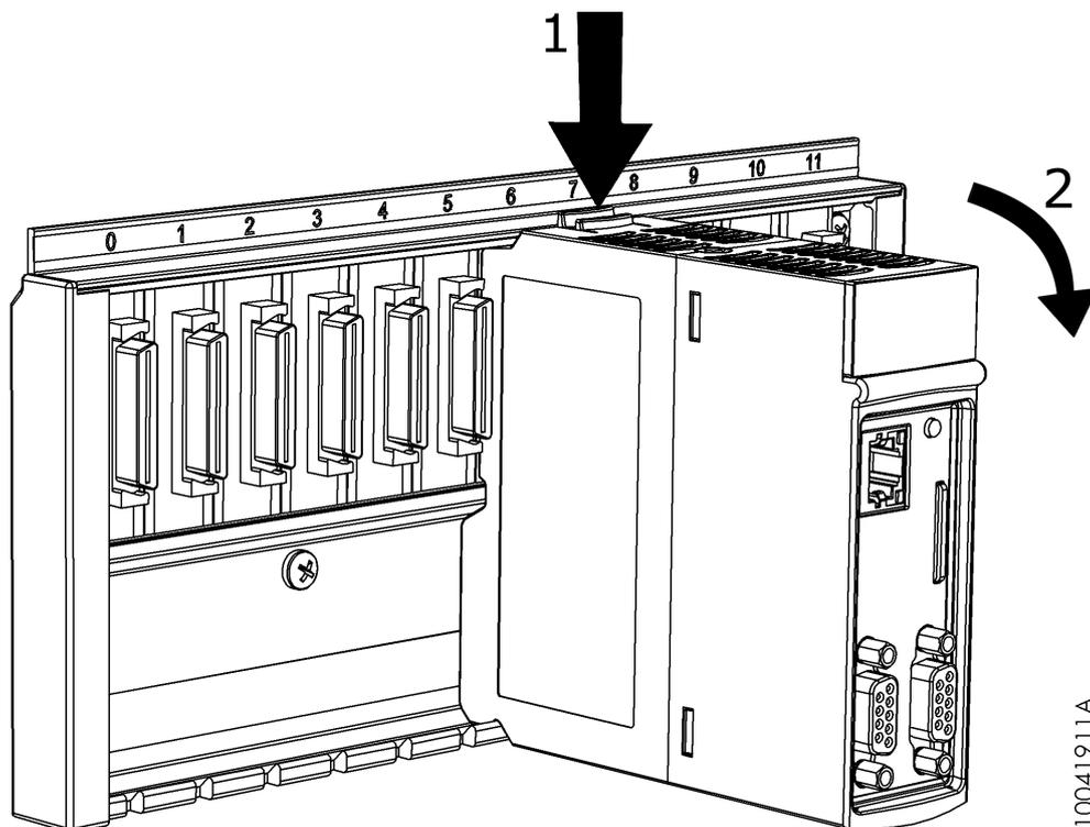
Figura 52: Desconexão do Barramento
