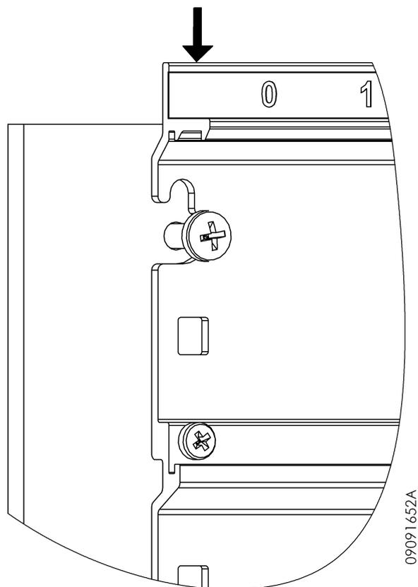
Figura 46: Fixação Bastidor – Encaixe nos Parafusos
