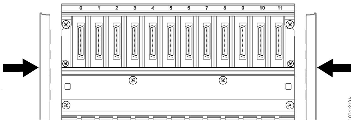
Figura 47: Fixação Bastidor – Fechamentos Laterais
