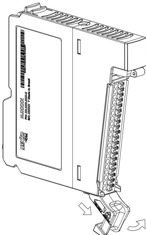
Figura 61: Remoção do Borne de E/S Módulo Nexto Jet
