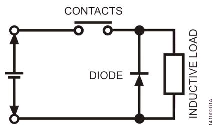
Figura 35: Circuito com diodo
