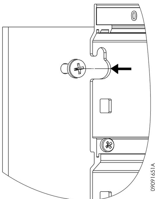
Figura 45: Fixação Bastidor – Alinhamento
