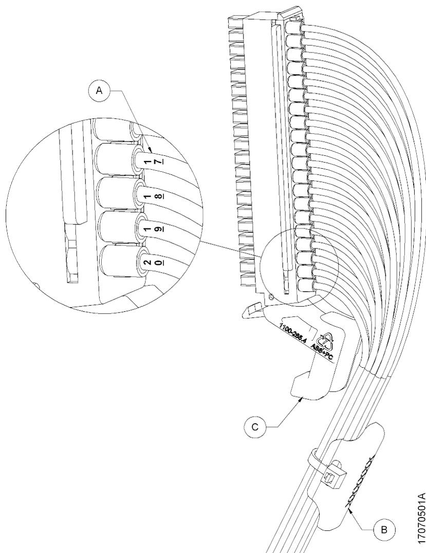
Figura 76: Identificação e Fixação da Fiação Nexto Jet
