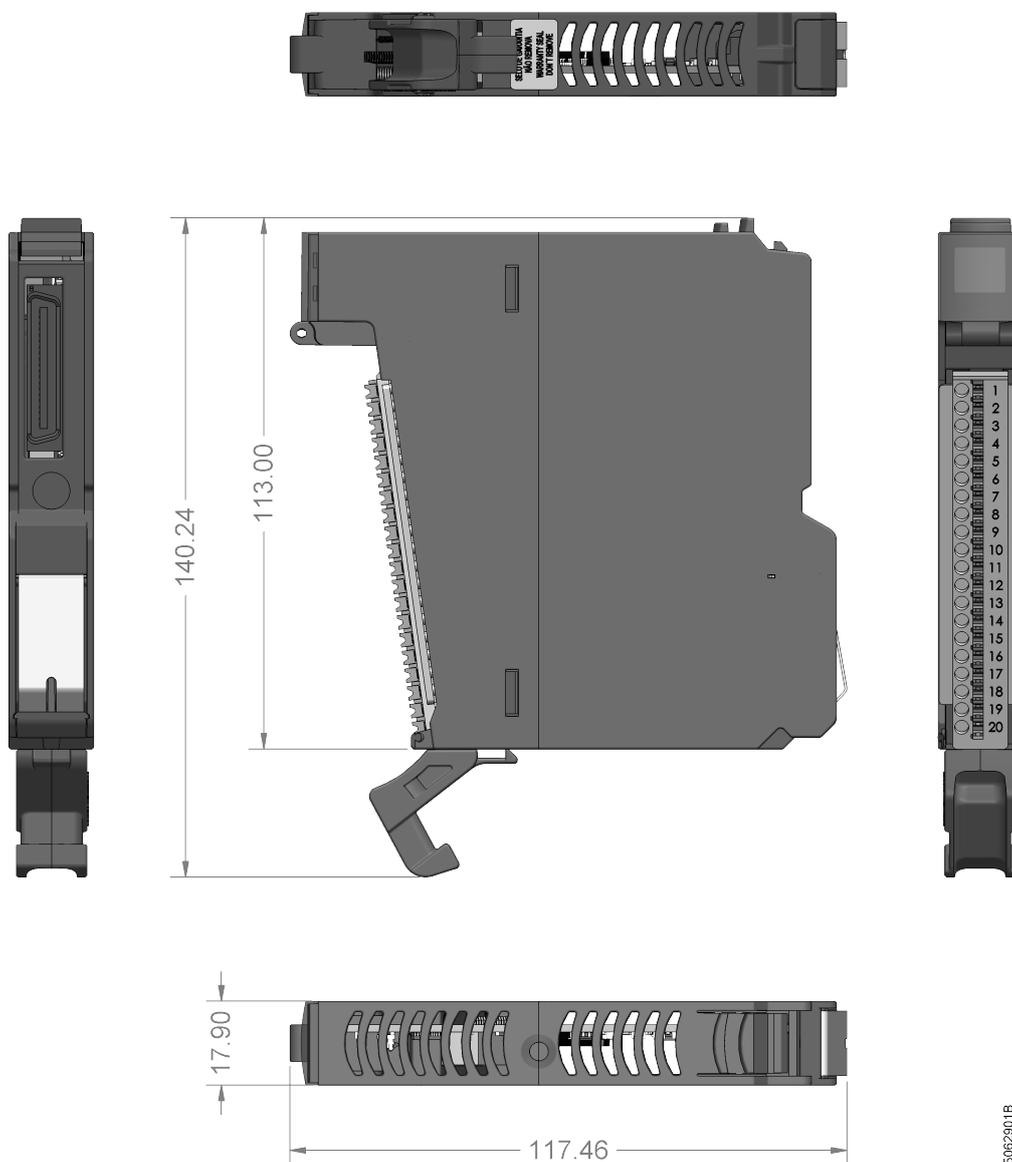
Figura 21: Módulo Nexto Jet de E/S de 18 mm
