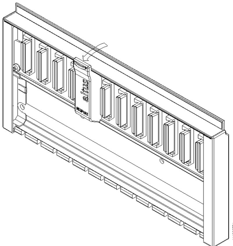
Figura 69: Remoção da Tampa de Conector de Bastidor
