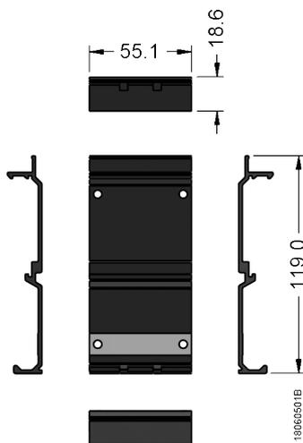
Figura 24: Base com 2 posições para montagem em painel
