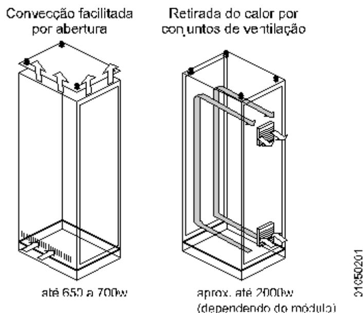
Figura 34: Exemplo de Movimentação do Calor – Instalação Aberta
