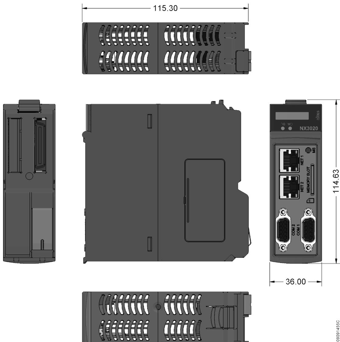
Figura 23: Módulo UCP NX3020 de 36 mm
