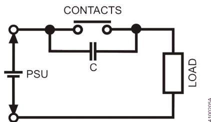
Figura 40: Circuito com capacitor em paralelo com contatos
