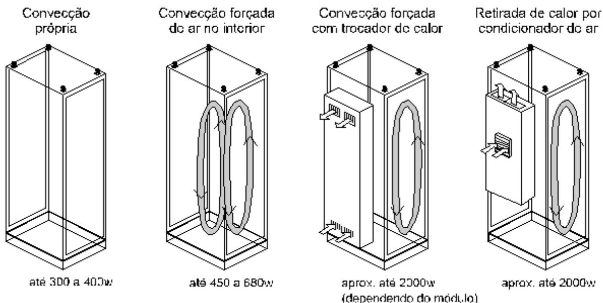
Figura 33: Exemplos de Movimentação do Calor – Instalação Fechada
