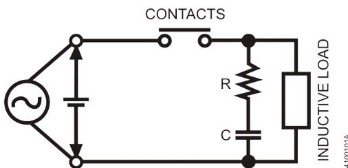
Figura 39: Circuito RC paralelo com a carga
