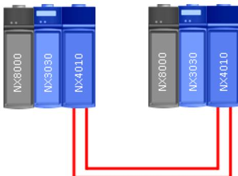
Figura 14: Configuração Mínima de um CP Redundante - NX3030
