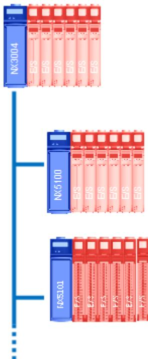
Figura 12: Cabeça de Rede de Campo MODBUS
