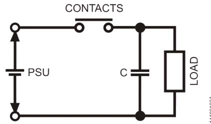
Figura 41: Circuito com capacitor em paralelo com a carga
