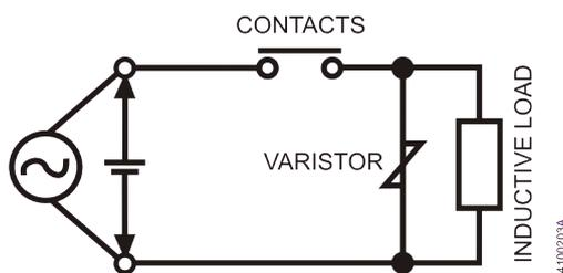
Figura 37: Circuito com varistor
