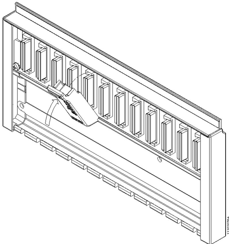
Figura 68: Inserção da Tampa de Conector de Bastidor
