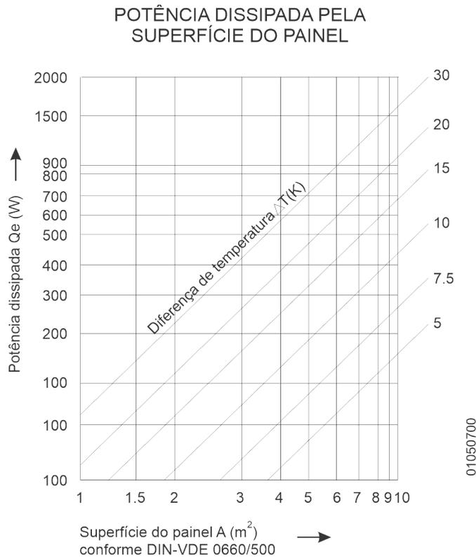
Figura 32: Potência Dissipada x Superfície x Dif. de Temperatura
