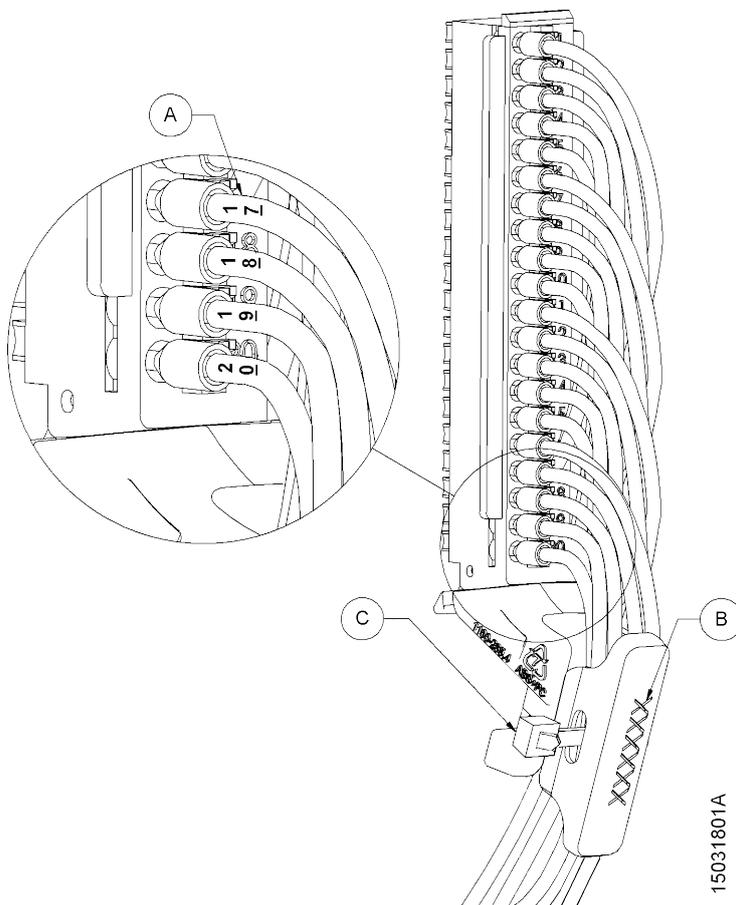
Figura 75: Identificação e Fixação da Fiação Nexto
