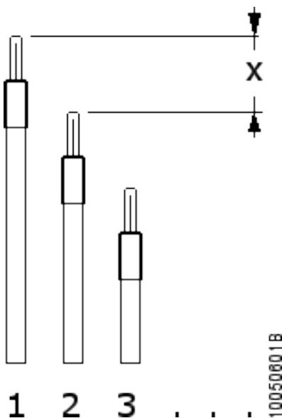
Figura 73: Corte Fiação
