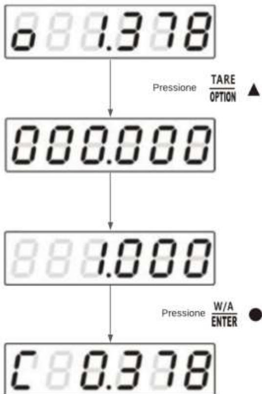
1) No passo 7 da calibração, aperte **TARE** / **OPTION** ▲ para inserir manualmente o valor zero em milivolt.
