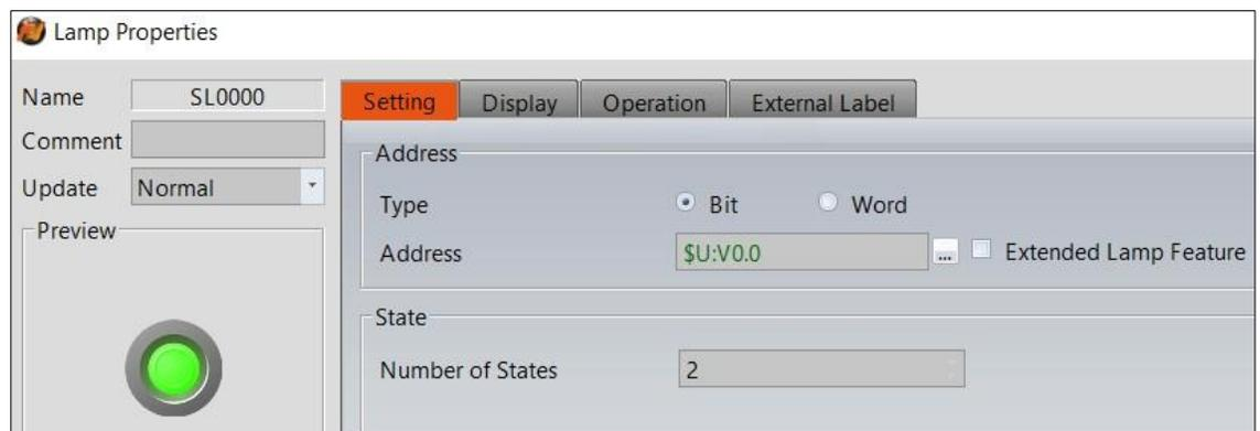
Figura 5-133. Configuração da Lâmpada
