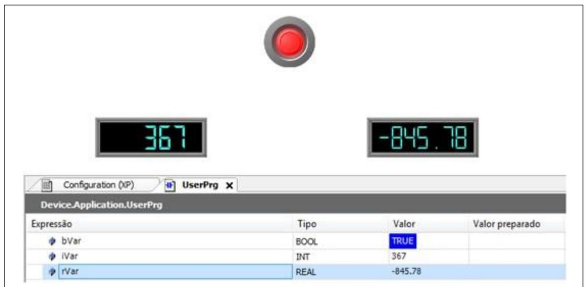
Figura 5-159. Tela da comunicação Modbus em operação
