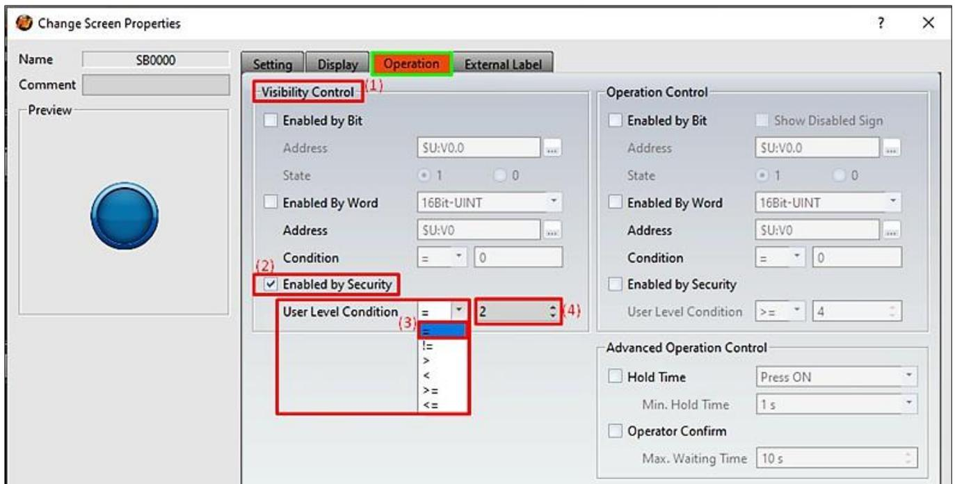
Figura 5-65. Configuração do objeto Trocar Tela (Controle de Visibilidade)
