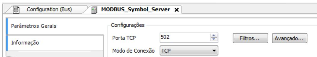
Figura 77: Tela de Configuração Parâmetros Gerais MODBUS Servidor
