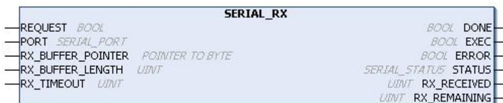
Figura 118: Bloco para Ler Valores do Buffer de Recepção
