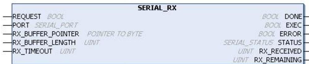
Figura 113: Bloco para Ler Valores do Buffer de Recepção
