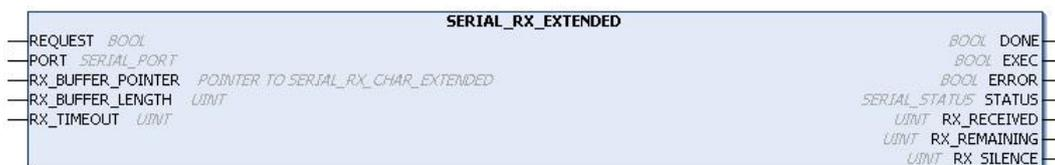
Figura 114: Bloco para Leitura do Buffer de Recepção
