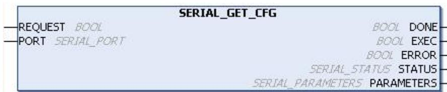
Figura 109: Bloco para Capturar a Configuração da Serial
