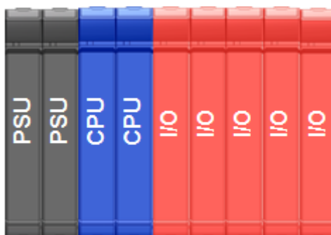
Figura 7: Redundância de UCP e Módulo Fonte de Alimentação
