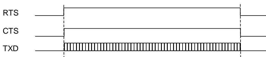
Figura 6-5. Timing dos sinais RTS, CTS e TXD
