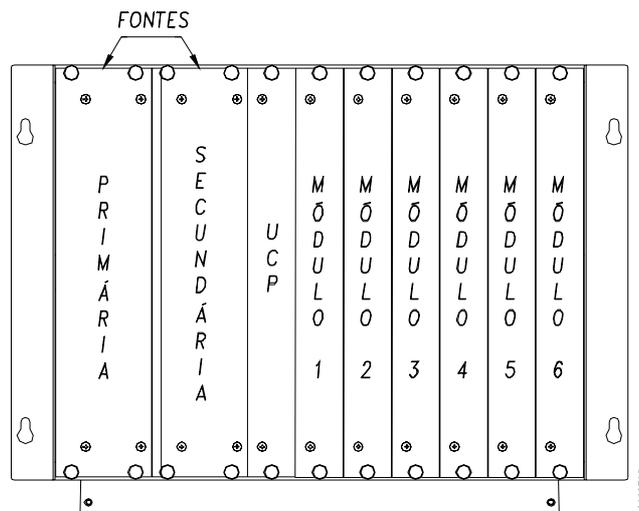
Para instalação dos módulos, fontes e UCP é necessário inseri-los de forma a deslizar através dos trilhos inferiores e superiores até completa conexão com placa posterior do barramento. Para o encaixe completo é necessário aparafusar todos os módulos junto ao bastidor utilizando os manipuladores presentes no painel frontal dos próprios módulos.
