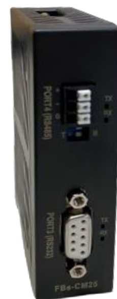
FBs-CM25 Módulo de comunicação serial 1 x RS-232 e 1 x RS-485
