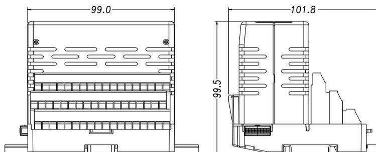
Ao lado o Módulo PO1113 montado numa base com fusíveis de proteção PO6101, PO6104 ou PO6151 e trilho DIN TS35.
