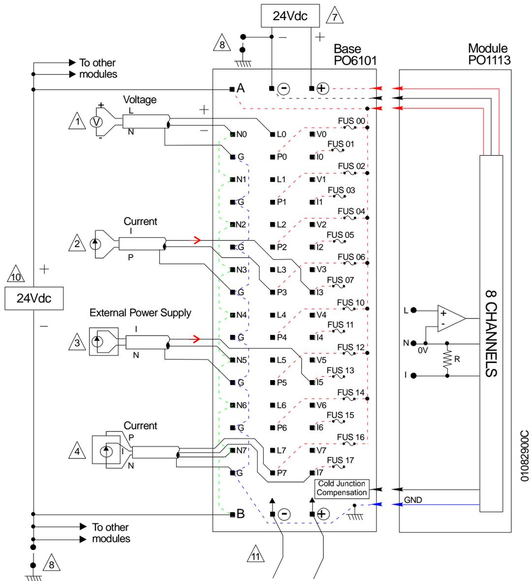
A figura abaixo demonstra a ligação elétrica do módulo PO1113 com as bases analógicas PO6104 ou PO6004. Para a base P6004 os fusíveis, indicados na figura como FUS 0x, devem ser desconsiderados.
