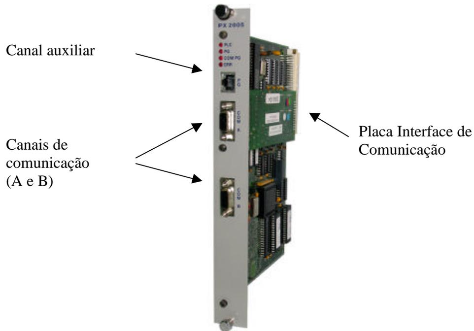
Figura 2-1: Painel do Processador PX2005
