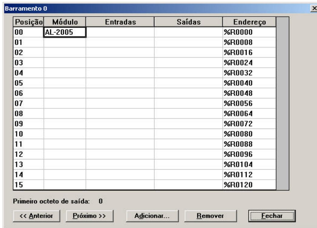
Figura 3-1 Tela de Configuração do Barramento no Programador MasterTool
