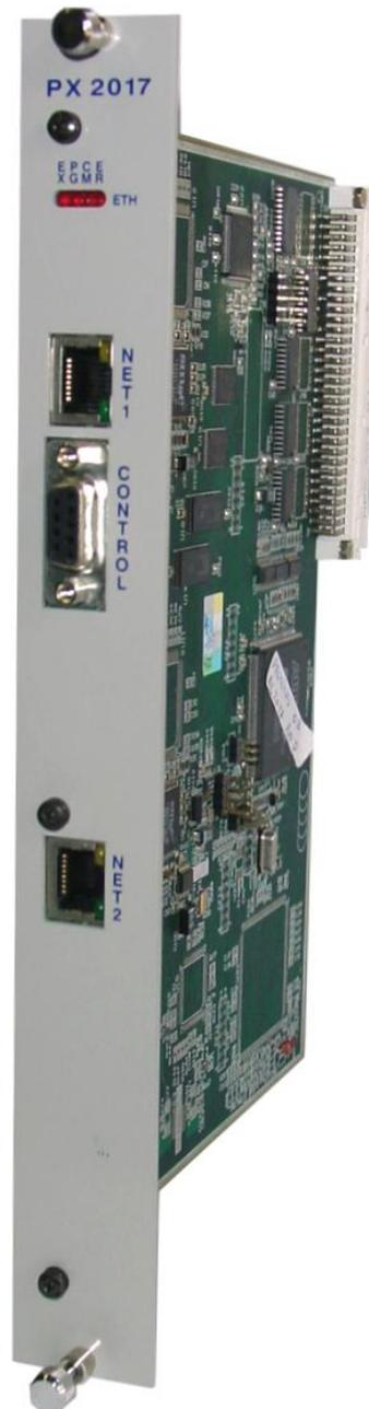
Figura 2-1. Coprocessador de redundância PX2017
