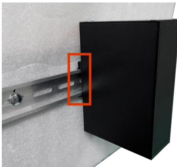
Figura 33: Estabilize o switch no trilho DIN
