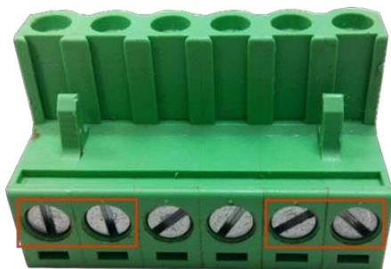
Figura 26: Bloco Terminal de Alimentação
