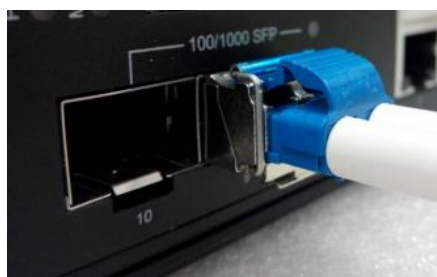
Figura 22: Conector LC para o transceptor
