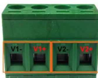
Figura 27: Bloco de terminais de energia
