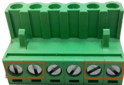
Figura 28: Bloco Terminal de Alimentação
