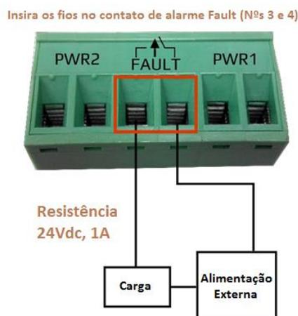
Figura 31: Conectando o Contato de Alarme Fault nos Switches ET5-0500, ET5-0600, ET5-0602-M, ET5-0802-M, ET5-0800 e PG5-1204-SFP.
