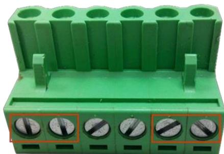
Figura 28: Bloco Terminal de Alimentação
