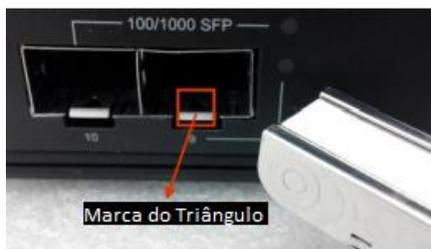
Figura 22: Transceptor para o módulo SFP
