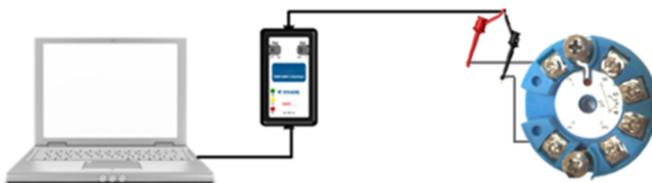
Esquema de ligação da interface ACI10-UH alimentando o ATT10-H.
