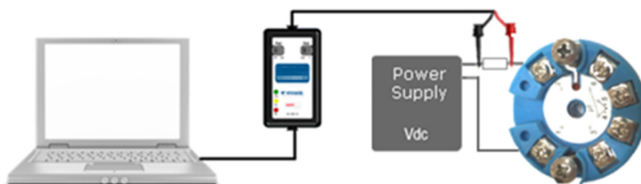
Esquema de ligação da interface ACI10-UH ao ATT10-H com alimentação externa.
