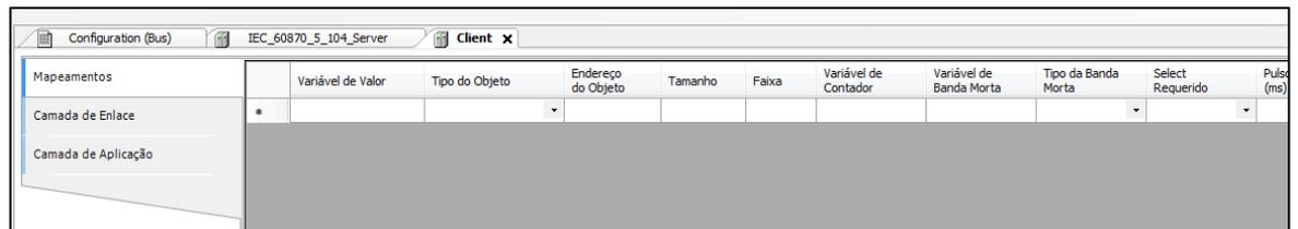
Figura 4-72. Tela de Mapeamento dos Dados do Servidor IEC 60870-5-104
