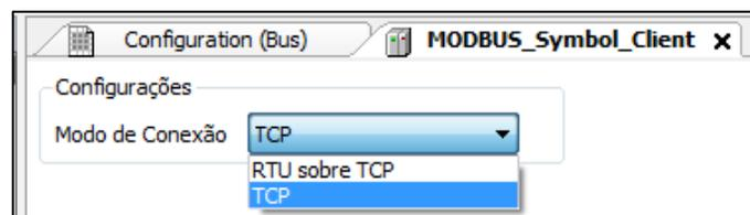
Figura 4-50. Tela de Configuração Parâmetros Gerais MODBUS Cliente
