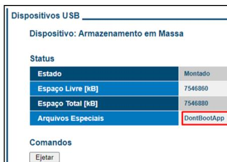
Figura 4-31. DontBootApp no dispositivo de armazenamento em massa
